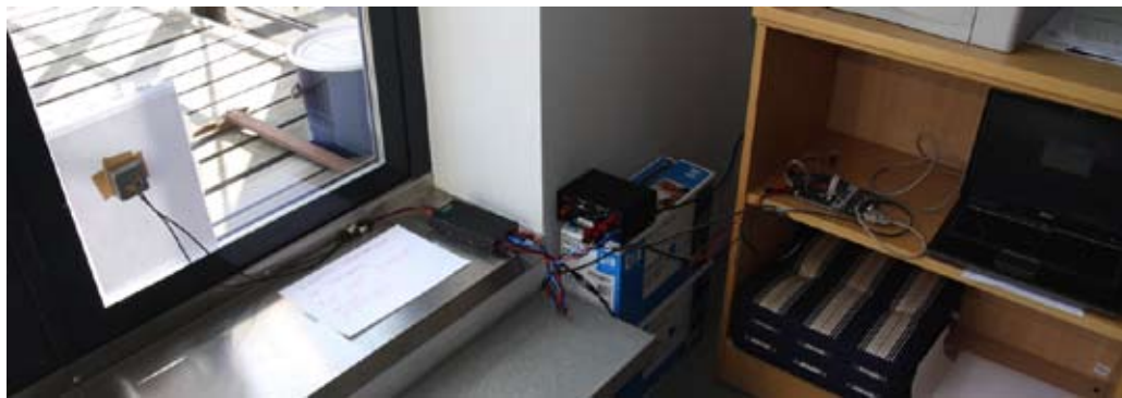
Kuva 1. Auringonpaistetta mitanneen laitteiston järjestely. Vasemmalla ikkunaan teipattu paperiarkki ja fotodiodi. Fotodiodin signaali luetaan vahvistimen kautta AVR-laudalle, joka syöttää tietokoneen sarjaporttiin aikaleimaa ja fotodiodin jännitelukemaa.
