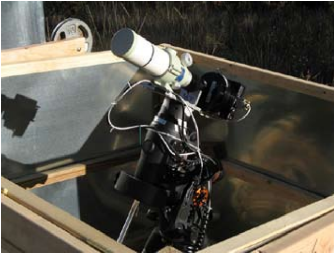
AAVSO:n Bright Star Monitor (BSM) koostuu 6 cm:n laajakenttäisestä teleskoopista ja CCD-kamerasta. Laitteisto on automatisoitu. Se sijaitsee Uudessa Meksikossa Yhdysvalloissa. Kuva: AAVSO.
