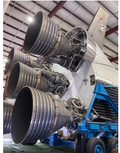
Saturn-raketin ensimmäisen vaiheen viisi F-1 rakettimoottoria.
