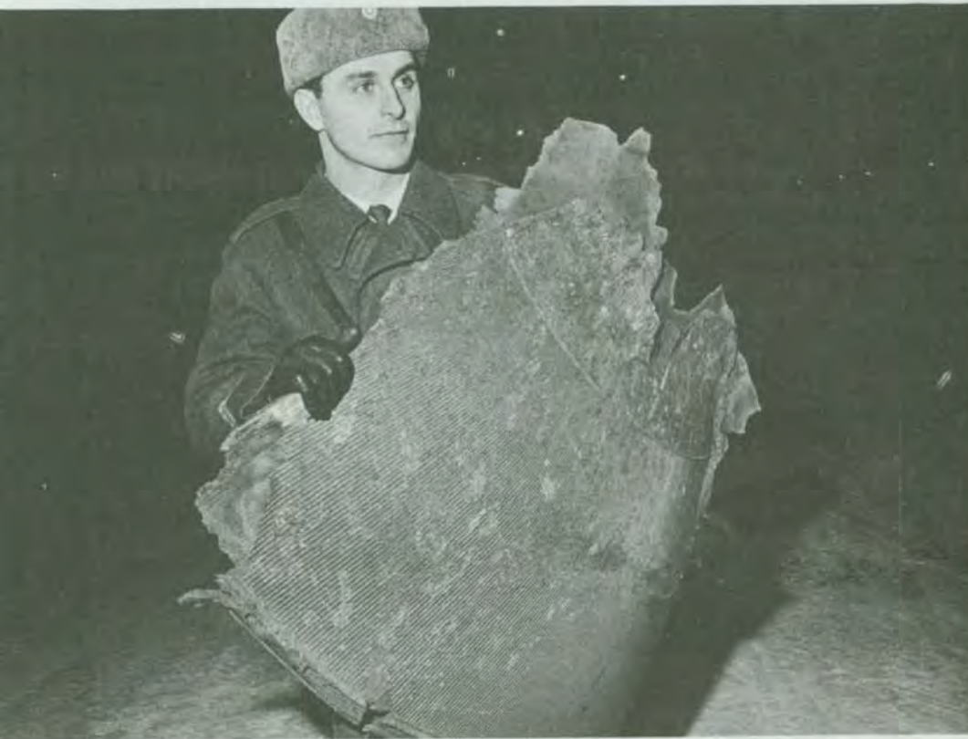
Suomeen putosi joulukuussa 1967 osia neuvostoliittolaisesta Kosmos 194-tekokuun kantoraketista. Suurin osa oli vajaan metrin läpimittainen monikerroksinen levy, joka on kuvassa lennätetty Kuopiosta Seutulan lentokentälle Helsinkiin. (Lehtikuva).
