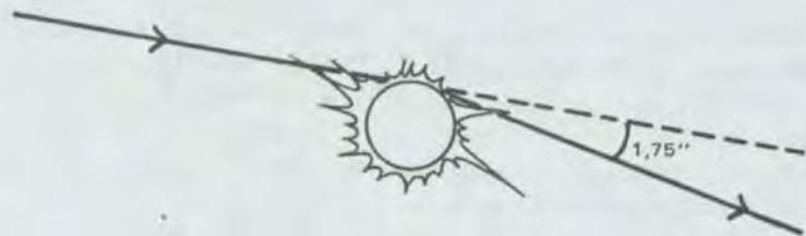
Auringon reunan ohi kulkevat valonsäteet tai radioaallot taipuvat 1,75 kaarisekuntia. Kauempana Auringosta taipuma on pienempi.
