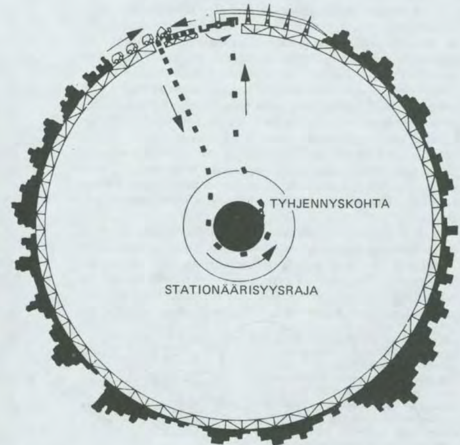
Korkealle kehittyneen sivilisaation menetelmä energiapulman ja jäteongelman yhtäaikaiseksi ratkaisuksi. Kaupunki on rakennettu pyörivän mustan aukon ympärille. Jätteet pudotetaan aukkoon, ja aukon ergossfääri lähettää kuljetusastiat kovalla vauhdilla takaisin ylös. Ne siepataan talteen, ja sieppauksessa ne käyttävät sähkögeneraattoreita. (Kuva Misner-Thorne-Wheeler, Gravitation, s. 908).
