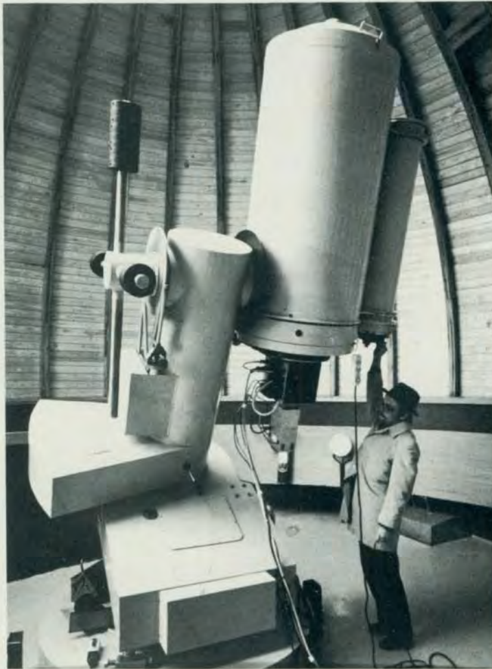
Kuva 2. Metsähovin 60 cm Ritchey-Chrétien-teleskooppi. Teleskooppi seisoo betonipylvään päässä. Kallellaan oleva tuntiakseli on Maan akselin suuntainen. Akselin alapäästä vasemmalle näkyy kaukoputkea tasapainottava vastapainolaatikko. Mittalaitteita vaihdettaessa kaukoputki voidaan nopeasti tasapainottaa uudelleen siirtämällä tai lisäämällä deklinaatioakselin jatkeella olevaan ristiin asetettuja apupainoja. Ohjaukaukoputki näkyy teleskoopin oikealla sivulla. Kun havainnot aloitetaan, putkien kannet poistetaan. Pääpeilin kehysten takapintaan on kiinnitetty fotometri-polarimetri. Ohjaus- ja korjausliikunnot hallitaan kehysten korvasta riippuvalla ohjausrasialla. – Valok. Matti Kajantie.
